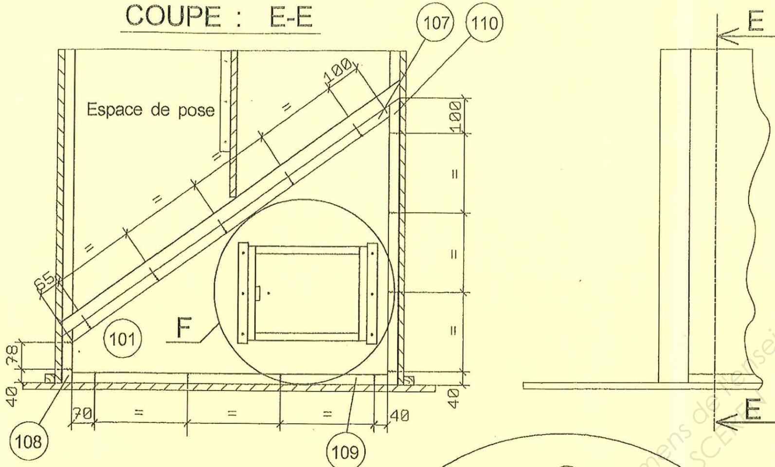
Positionnement des vis VBA 4.5 x 45 sur les éléments 107, 108, 109, 110.
